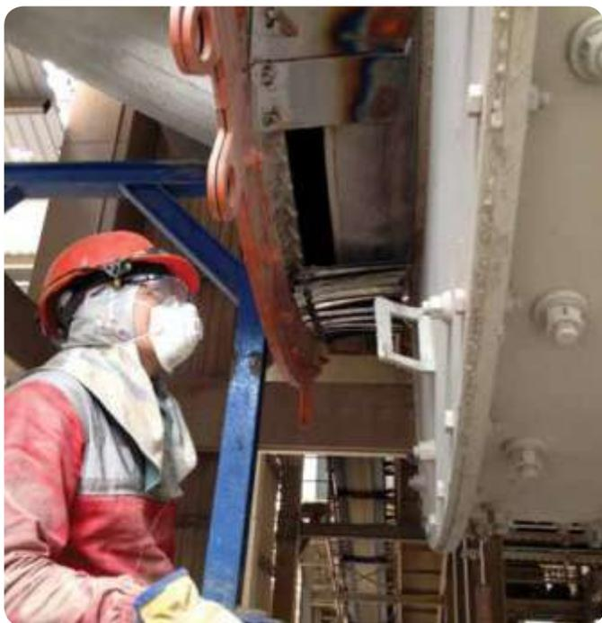
Esta imagen detalla la continua inspección que realizamos a cada una de las 320 laminillas que conforman la totalidad del sello verificando su estado. Tomando muy cuenta la velocidad del molino, la variación de la temperatura en el proceso al momento de alimentar el molino y la deformidad radial del mismo.
